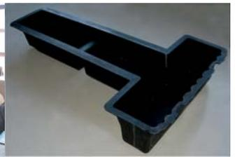
Fräsform Abdeckung aus 670ger Blockmaterial
