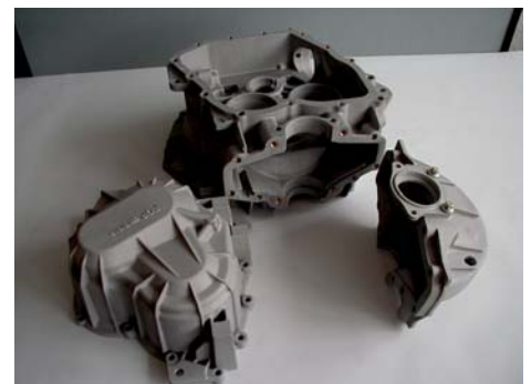
Getriebegehäuse CJP mit Gewindeeinsätzen für Einbau- und Montageuntersuchungen
